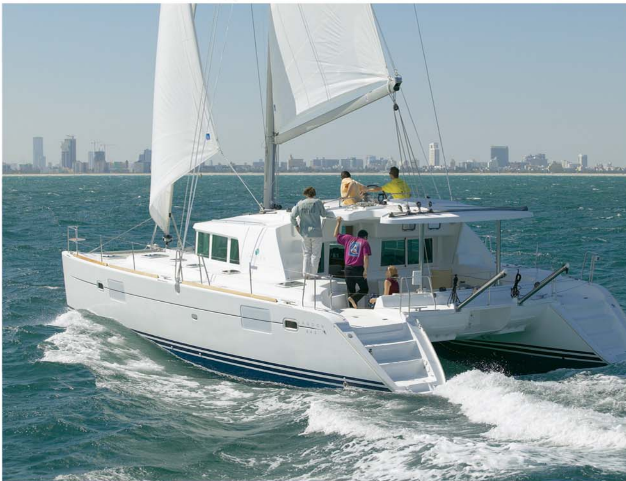
Une timonerie perchée sur le toit de la cabine et complètement séparée permet de ne pas mélanger la vie à bord et la navigation
